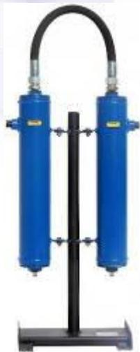
Фильтрационный модуль предназначен для тонкой очистки сжатого воздуха и различных газов от аэрозолей, масла и влаги, а также от твердых частиц размером менее 3 мкм. Обеспечиваемое остаточное содержание аэрозоля масла - менее 5 мг/м<sup>3</sup>. Используется в системах пневмоуправления и автоматики, пневмоприводе устройств и инструмента для окраски поверхностей распылением.
