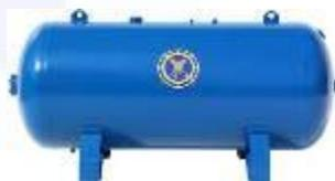
Компрессор размещен на **горизонтальном воздушном ресивере объемом 230л.** Бежецкий завод "АСО" более 80 лет производит воздухохорники разного объёма (от 10 до 900 литров) для сжатого воздуха давлением до 25 атм. Ресиверы окрашиваются на автоматической итальянской линии порошковой окраски.
